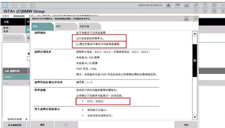
多次执行方向机“试运行”不成功，试运行所需的“方向稳定性偏差”参数缺失。
