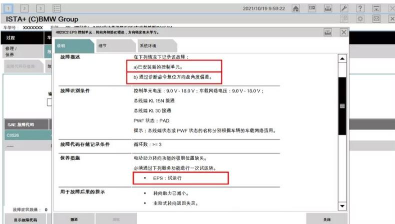
记忆极限位置时，必须将方向盘缓慢的完全向左和向右旋转一次，转向速度必须低于方向盘每秒转动1圈，在极限位置上缓慢提高转向力，直到方向盘不再继续转动。
