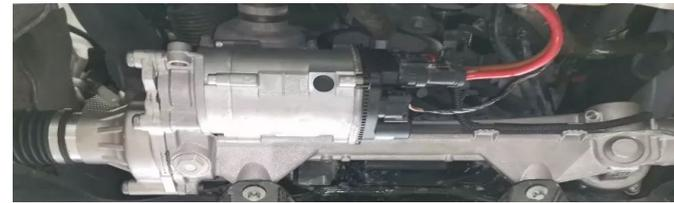
查看 ISTA 小齿轮转向角度数据流，无论方向盘如何变化，转向数据始终不变。
