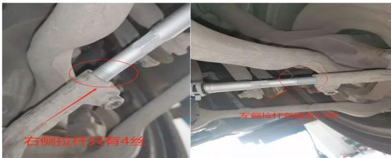
原来修理工在安装新方向机时没有按照厂家技术要求，方向盘位于正中间的位置，精确测量左右横拉杆安装长度，确保小齿轮位于齿条正中间位置，导致左右转向角度不一致。
